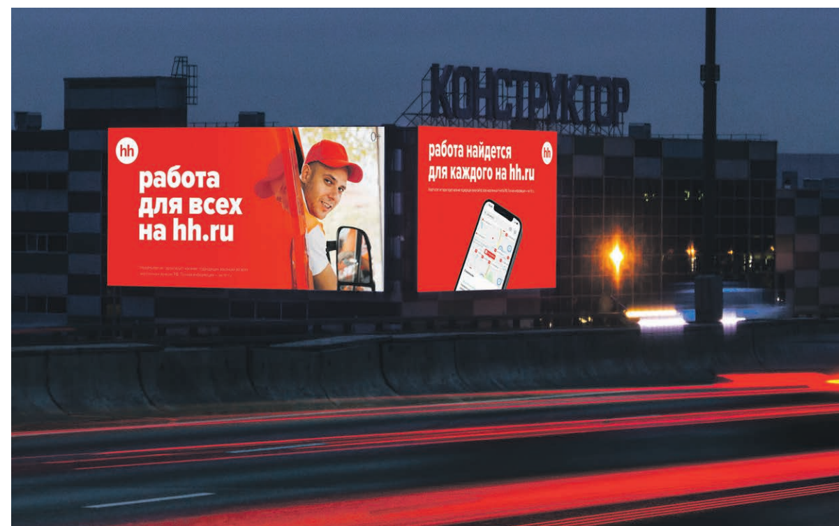
Медиафасады «Конструктора» отличаются повышенной яркостью (8 тыс. нит вместо стандартных 7,5 тыс.). Стабильную работу обеспечивает высокий класс пылевлагозащиты и термостойкости (от -40 до +60 °C)
