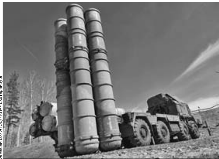
Зенитный ракетный комплекс С-300 «Фаворит» считается одним из лучших в мире. Он может полностью автономно наводить до 72 ракет на цели с расстояния до 200 километров. И, конечно, точно их поражать.
