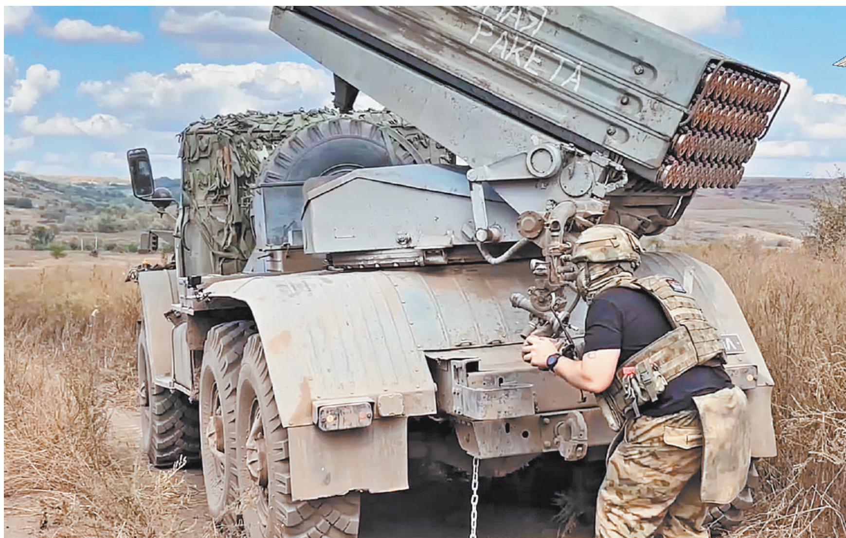
На снимке — боевая работа расчета реактивной системы залпового огня BM-21 «Град» Тульской дивизии ВДВ. Удар по противнику десантники наносят 122-мм неуправляемыми ракетами.
