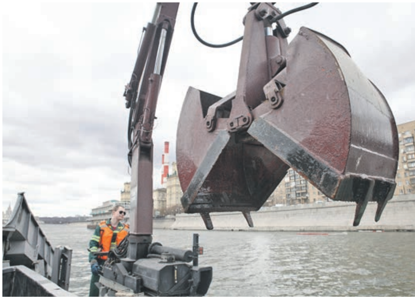
24 апреля 2015 года 12:15 Матрос самоходного мусоросборщика МС-3 Алексей Гончаров приводит в действие огромный ковш, который захватывает обнаруженный в воде мусор и поднимает его на борт. Все отходы увезут на специальную свалку и утилизируют
