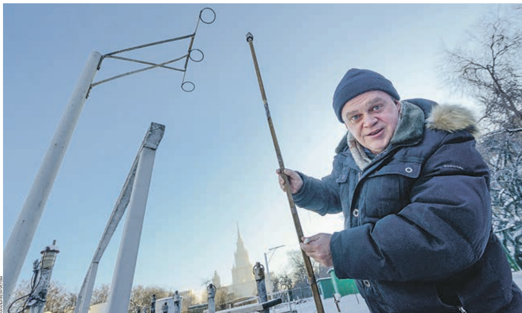
Вчера 12:15 Ведущий научный сотрудник метеорологической обсерватории МГУ Михаил Локощенко демонстрирует прибор, который называется мерзлотром. С его помощью специалисты могут определить, на какую глубину промерзла почва. Рекорд в столице составляет около двух метров, и этой зимой пока до него, к счастью, далеко
