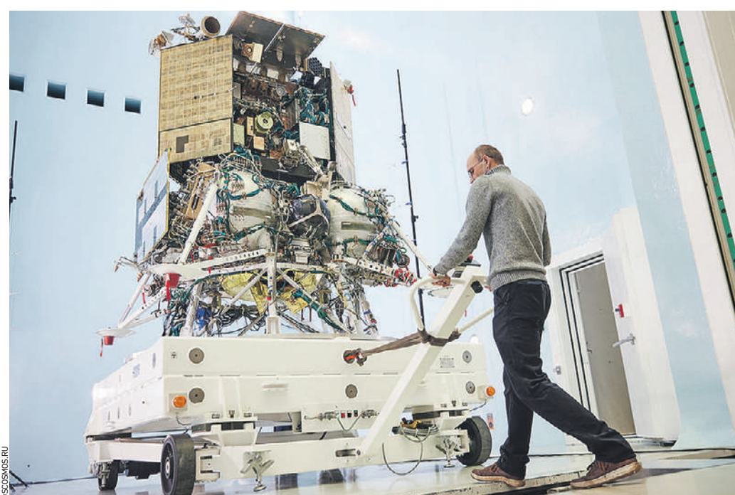
20 февраля 2021 года. Акустические испытания автоматической станции «Луна-25» в ракетно-космической корпорации «Энергия» имени С. П. Королева
