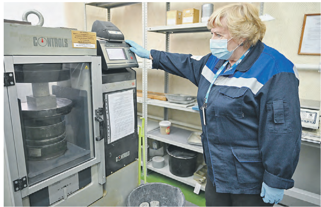
Вчера 12:01 Ведущий инженер ЦЭИИС Елена Измайлова проверяет образец бетона на прочность с помощью специального оборудования
