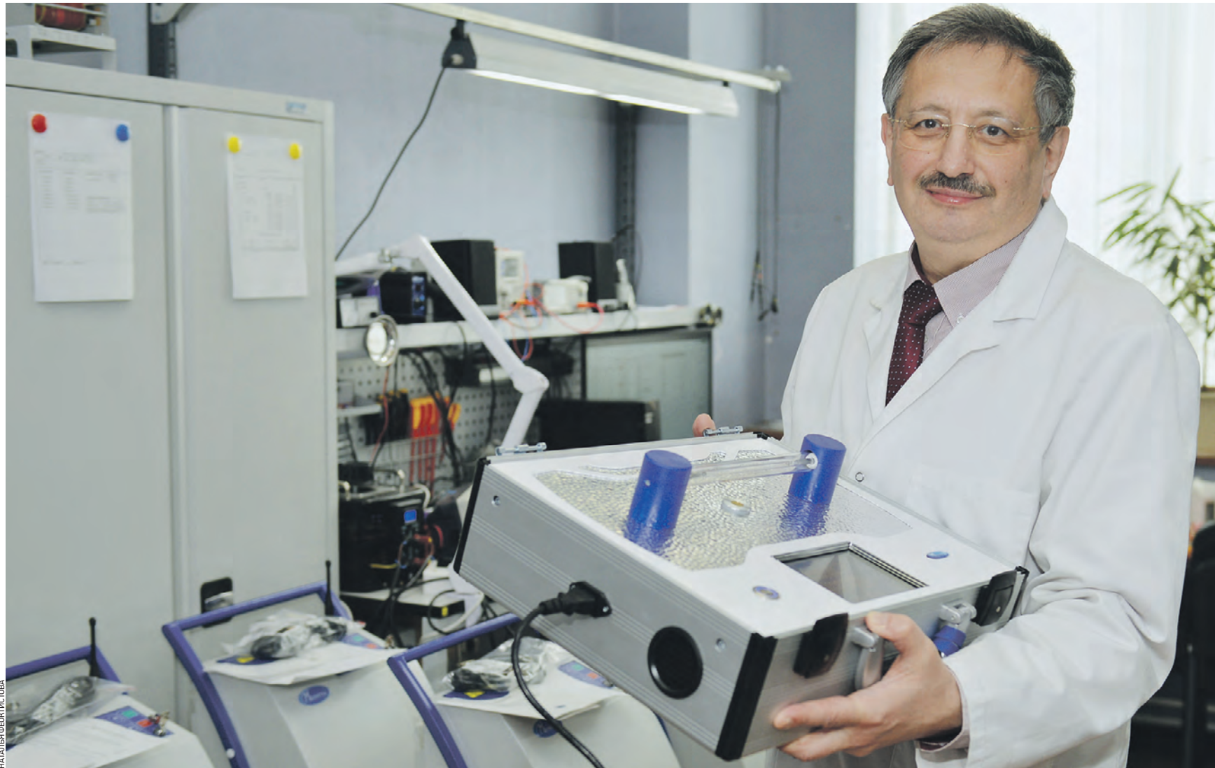
Вчера 14:29 Генеральный директор московской компании Яков Гольдштейн держит в руках установку для обеззараживания воздуха с ультрафиолетом сплошного спектра, которую производит и поставляет за рубеж их предприятие
