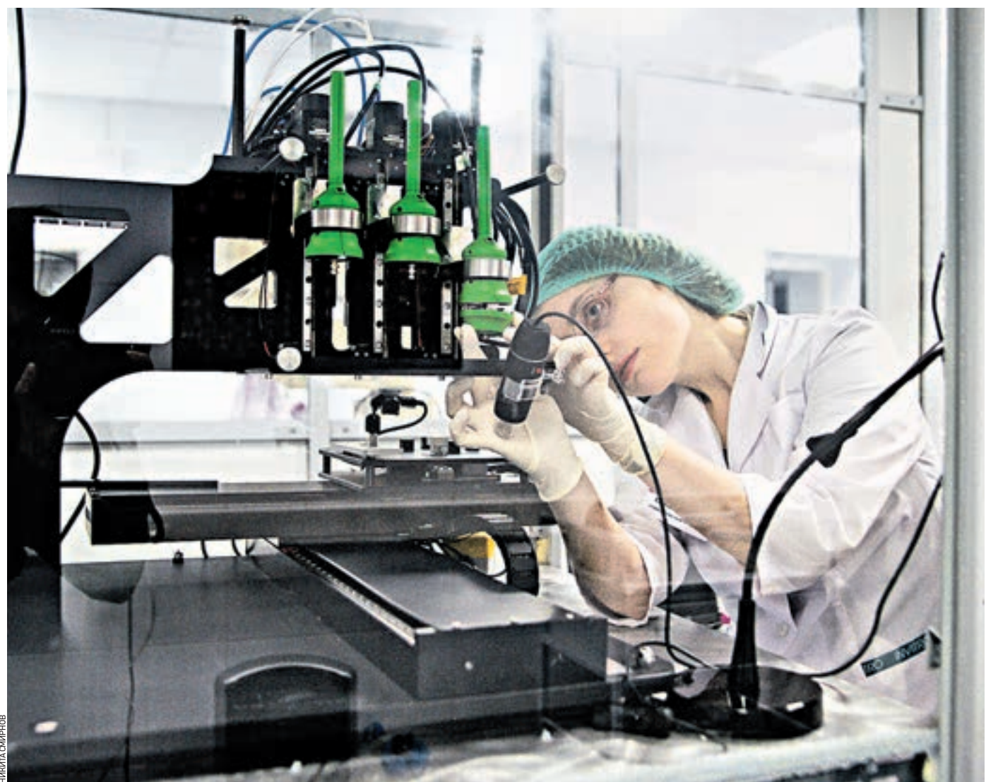
11 декабря 2014 года 15:25 Сотрудница лаборатории 3D Bioprinting Solutions подготавливает биопринтер к работе: проверяет ход форсунок (на фото — детали зеленого цвета). 15 марта он должен совершить сенсацию в научном мире
