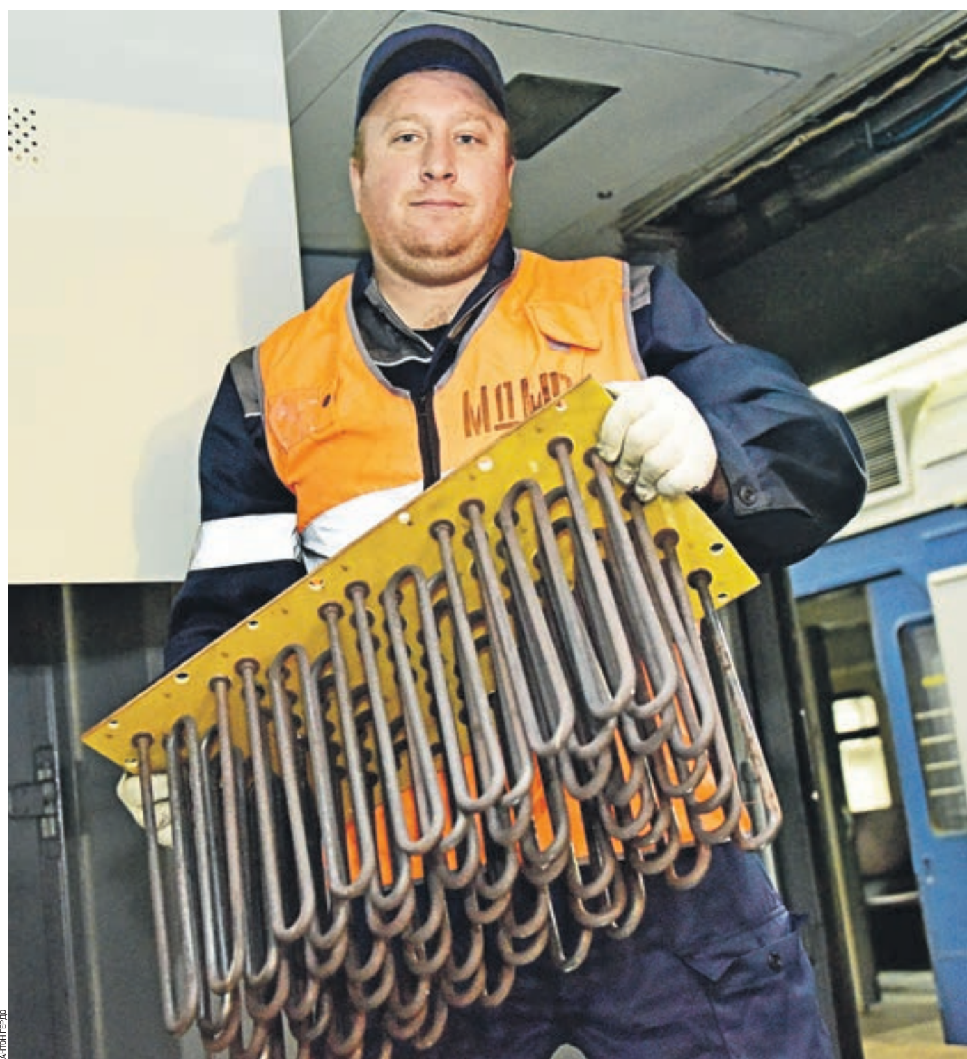
28 октября 11:00 Владимир Савостиков, мастер участка по обслуживанию тормозного оборудования, демонстрирует фотографа «ВМ» батарею, которая обслуживает теплым воздухом вагоны и обеспечивает комфортную поездку пассажирам
